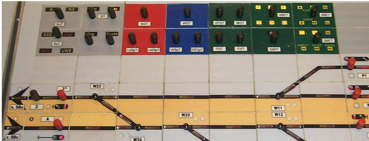
Die grauen Felder sind bis auf das Feld Stelltisch ein/aus ohne Funktion (oF). Rote Felder sind Signalgruppentaste (oF), Signalsperr- und Entsperrtaste. Blaue Felder sind Weichengruppentaste, Weichensperr- und Entsperrtaste. Grüne Felder sind Fahrstrassentasten: Umfahr-, Gruppen-, Hilfstaste und MGT (oF).
